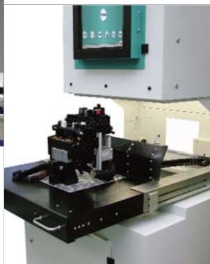
Detail: Ausgefahrene Schublade mit Prüflingsaufnahme
