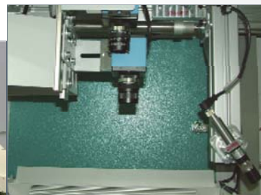
Innenansicht: Ausgereifte Kameratechnik für effiziente Bestückungsprüfungen
