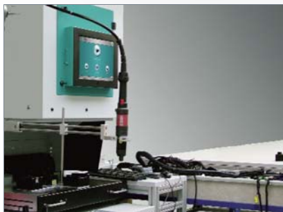
Optional: Schrauberstation zur Bestückungsfixierung
