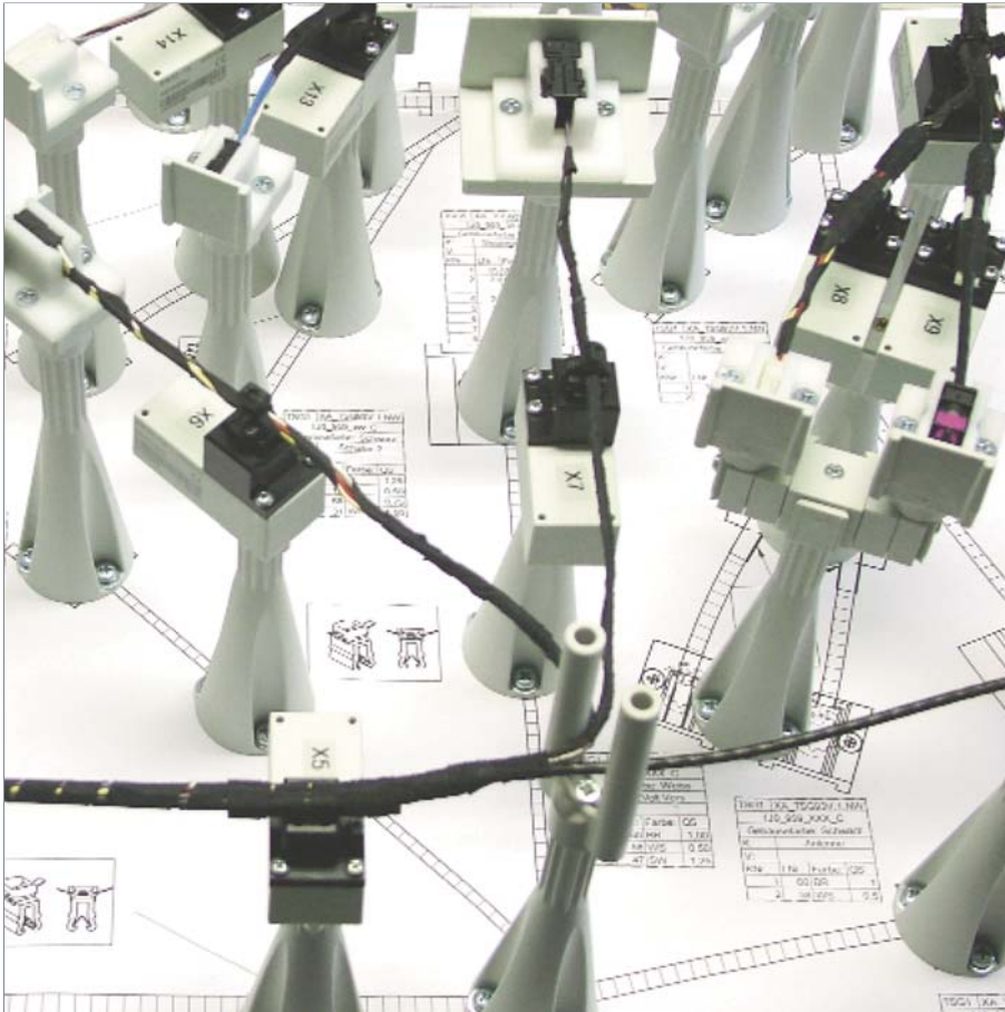
Beispiel für ein individuell gestaltetes Prüffeld mit WTS-Komponenten
