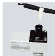
Die Präsenzabfrage eines Lochclips sichert die wesentlichen Parameter, wie Durchmesser & Mindestlänge
