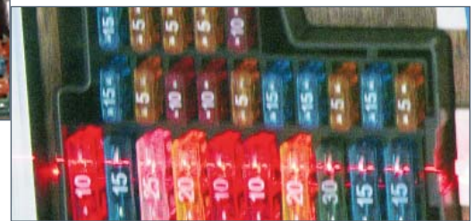
Laser bei der Erfassung der Prüfobjekte
