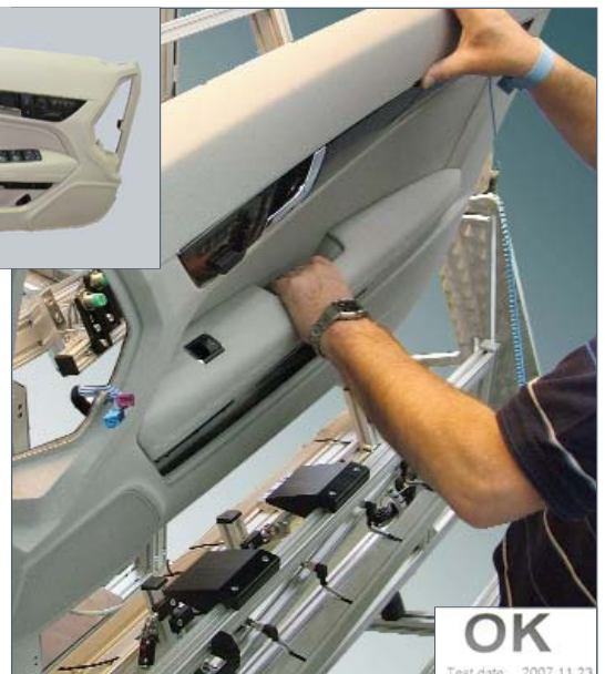
Anwendungsbeispiel: Einlegen einer Türinnenverkleidung in den Prüfstand
